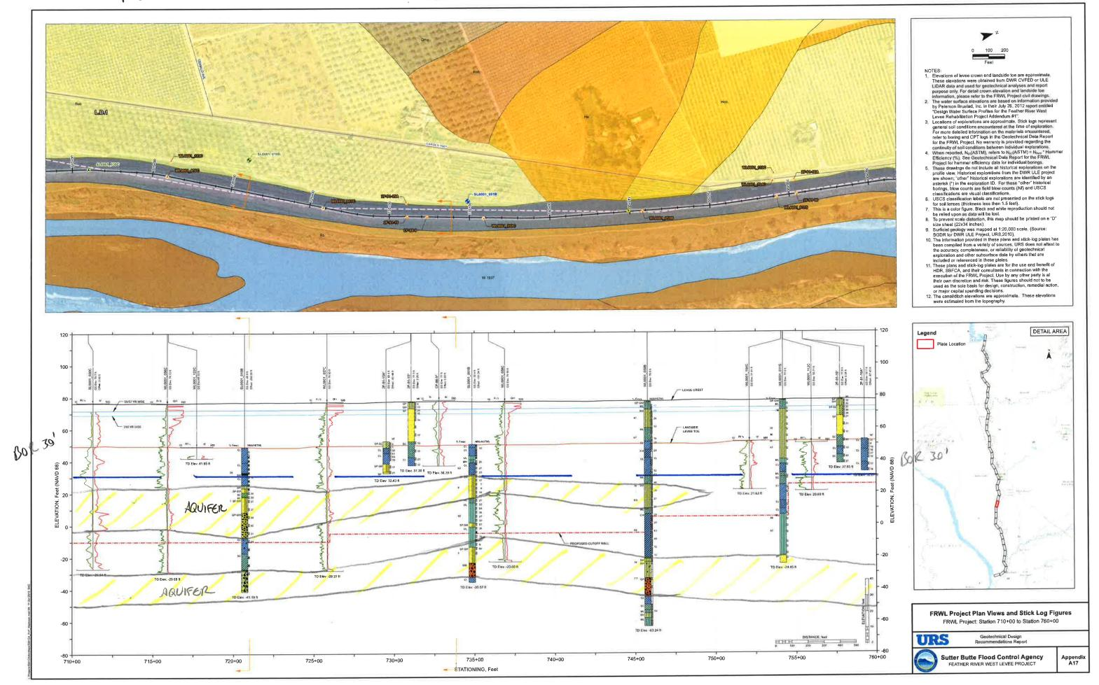
NEW WALL CUTS OFF UPPER AQUIFOR FROM ~ STA. 784+50 TO 827+50
